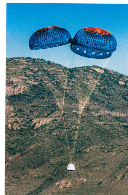
Il rientro della capsula del sistema New Shepard, della Blue Origin, per voli suborbitali.
